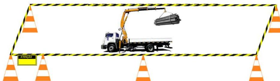
**Figura 7 - Exemplo de isolamento provisório constituído por cones refletivos e fitas zebreadas (carregamento/d Descarregamento de tubos da carroceria de um munck).**
