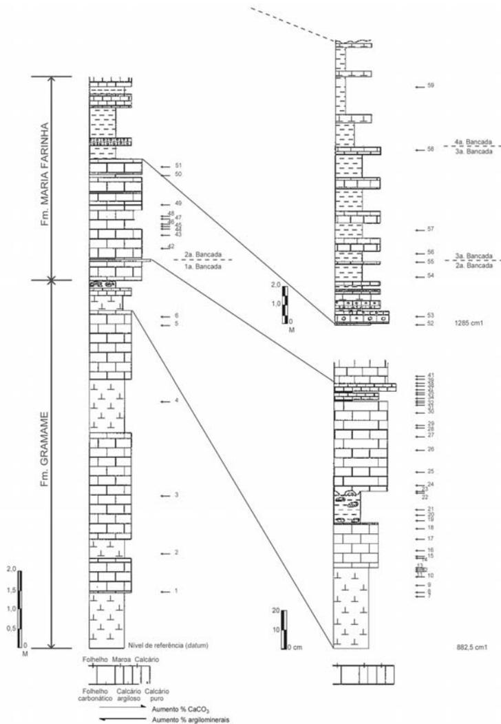
**Figura 4** - Seção geológica esquemática da pedra Poty. As posições estratigráficas das amostras 1-59 estão indicadas. Detalhes da seção (parte inferior, lado direito da figura) são também mostrados na Fig. 6. Os símbolos litológicos são os mesmos da Fig. 6. Ver outros detalhes no texto.
